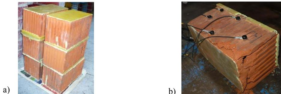
Fig. 3.5 a) Tabiques que serán ensayados, b) Tabique fallado por compresión.
