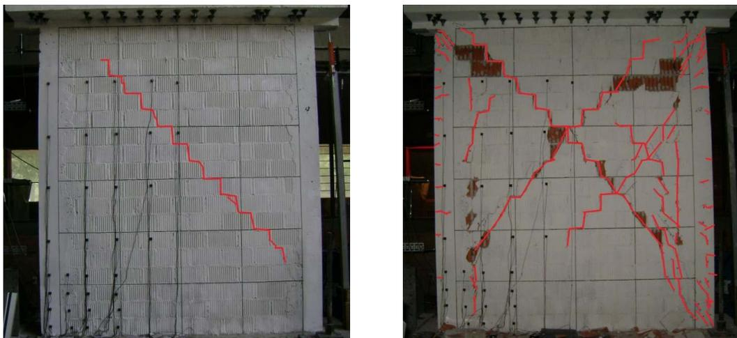
Fig. 4.10 Ensayo del muro ME3; a) Comienza a perder rigidez, se presentan las primeras grietas  $\gamma=0.0006$ , b)  $\gamma=0.008$ .
