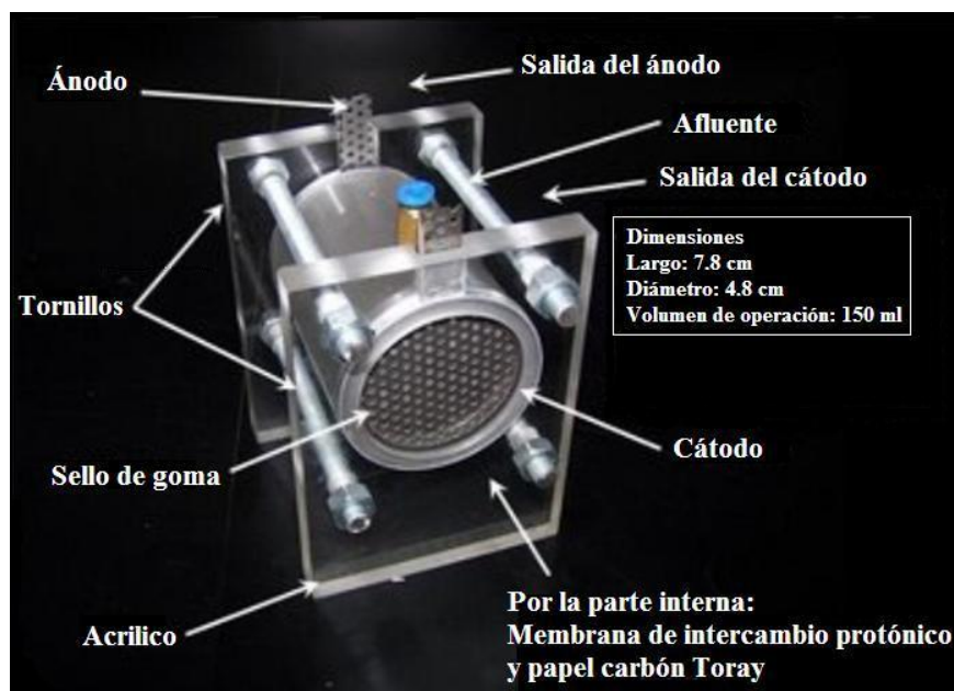
Figura 4.15 Diagrama de una CMB creada en México (Carmona-Martínez y col., 2006)
