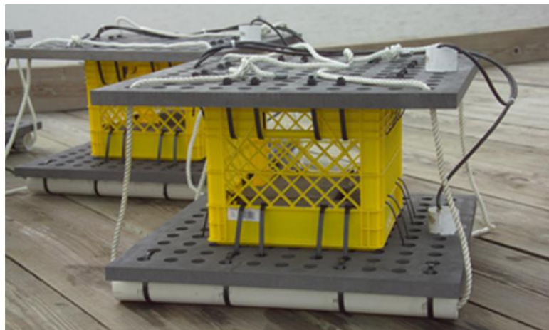
Figura 6.1 Siete subunidades conectadas eléctricamente en paralelo para proporcionar potencia suficiente para a la boya (Tender y col., 2008)
