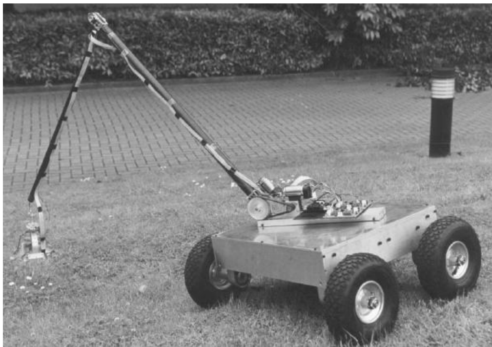
Figura 6.17 Robot que se alimenta de babosas (Slugbot) (Greenman y col., 2003)
