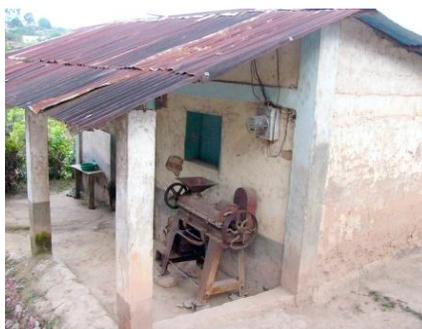
Foto 15: despulpadora. Fotos C.S.
