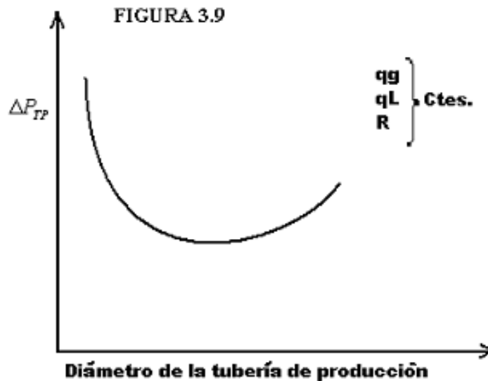
Figura 5.10 Caídas de Presión en TP con Distintos Diámetros
