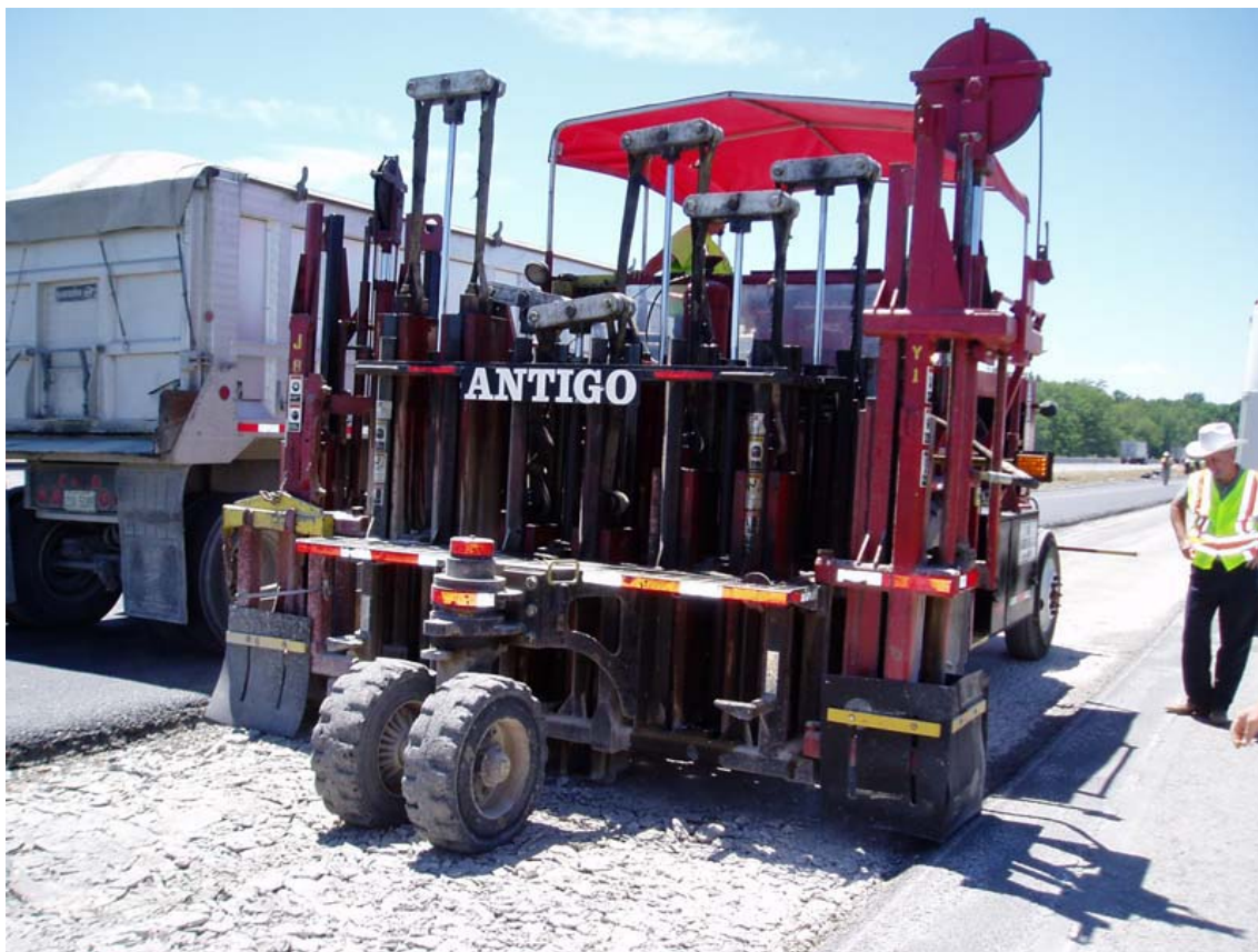
Figura 2.26 Equipo Multi-Head Breaker, Badger Breaker (Antigo Construction Inc.).
