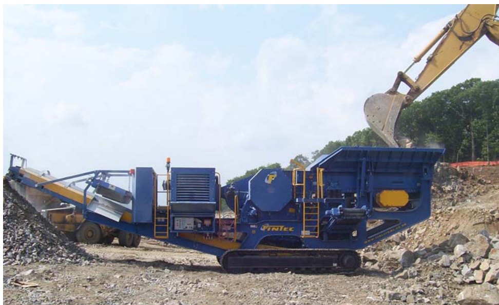
Figura 2.6 Equipo de trituración a base de quijetas, montado sobre orugas (FINTEC crushing & screening ltd, 2009).
