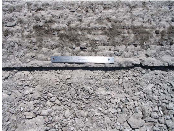
Figura 2.13 Comparación de la superficie de material intacto y triturado de un pavimento de concreto después del proceso de rubblizing (RMI, Inc.).
