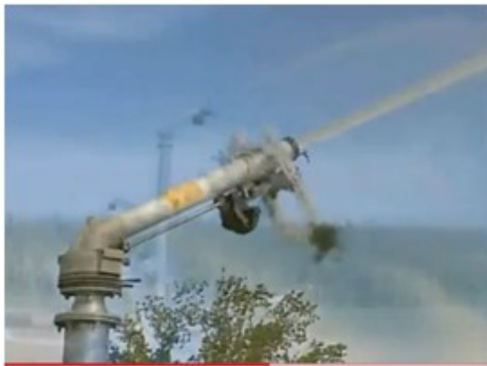
Figura 20: Sistema de riego por aspersión con cañones
