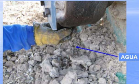
VACIAR POR EL TAPÓN DE DRENAJE HASTA QUE DEJE DE SALIR AGUA Y COMIENCE A SALIR ACEITE
