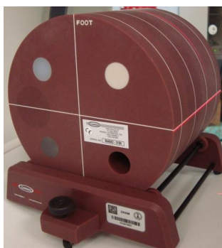
Figura 6.5 Maniquí del ACR para evaluar la calidad de la imagen.
