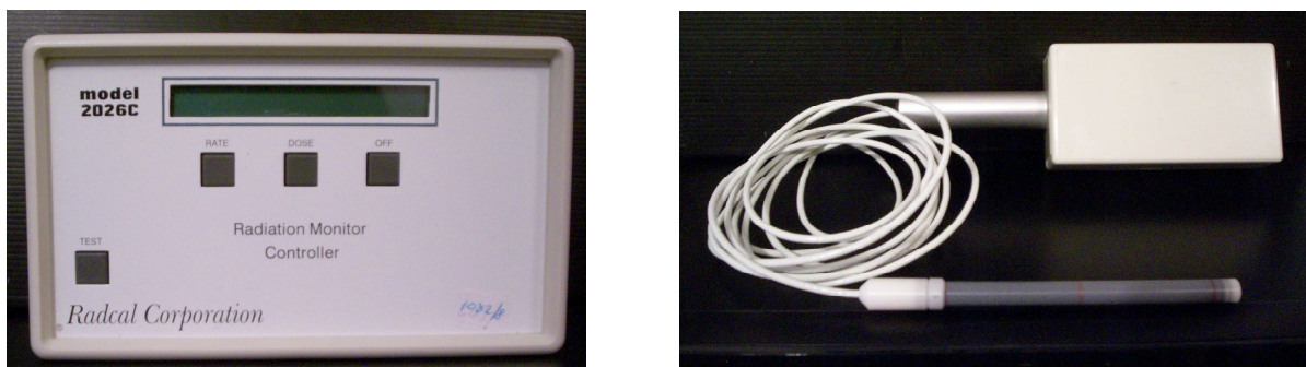
Figura 6.3 Cámara de ionización y electrómetro utilizados
