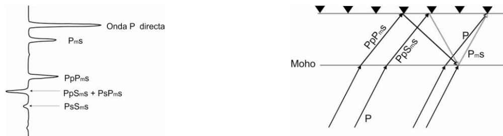
Figura 3.1. Diagrama idealizado de una FRP (izquierda) y las trayectorias de los rayos de las fases convertidas P a S (derecha) que componen la señal de la FRP . Modificada de http://eqseis.geosc.psu.edu (izquierda) y Sodoudi (2005) (derecha).
