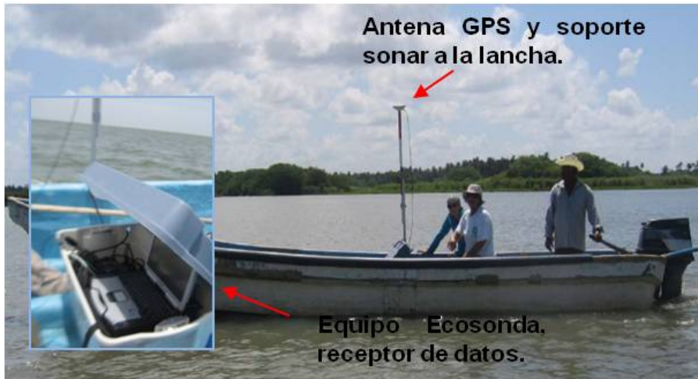
Figura A 2 Sistema de medición del fondo de la laguna - Ecosonda
