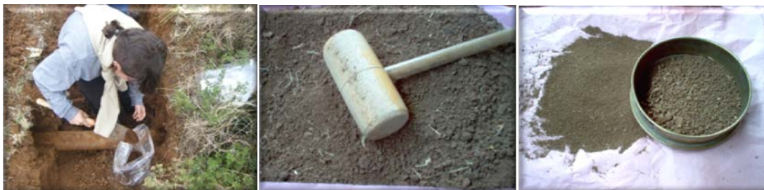
Figura 6. Preparación de muestras de suelo en contacto con tubería.
