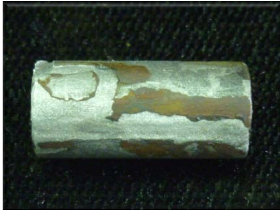
Figura 59. Probeta en contacto con Penicillium sp., durante 56 días
