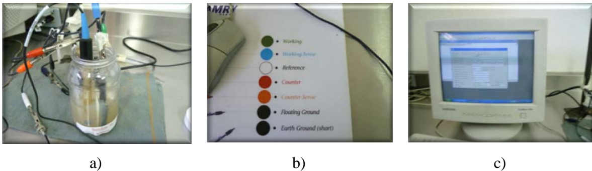
Figura 18. a) Celda de trabajo, b) Disposición de los electrodos c) Vista de la pantalla de Gamry Framework
