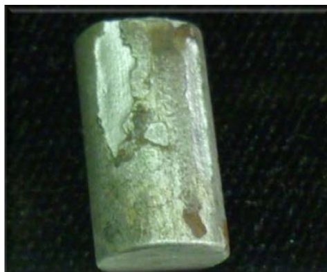
Figura 56. Probeta en contacto con Aspergillus sp. durante 64 días
