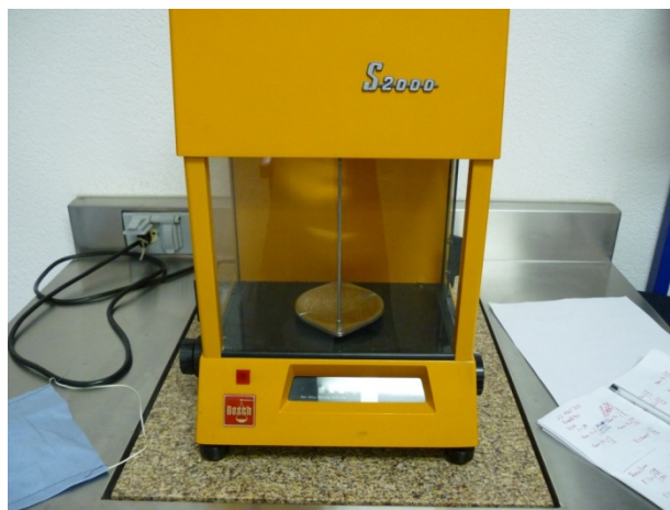
Figura 44. Balanza para obtención de masa inicial y masa final en cada probeta
