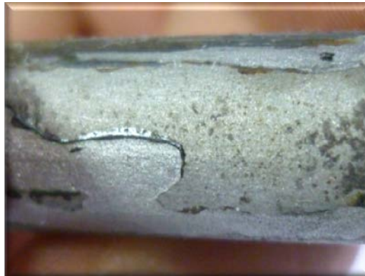
Figura 55. Probeta en contacto con Aspergillus sp. con 16 días de exposición
