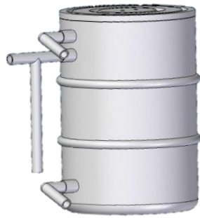
Figura 52: Termotanque con conexiones
