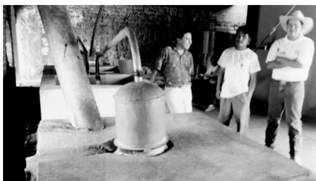
Figura 3.53. Destilación del mosto fermentado en alambique de cobre, para la elaboración del mezcal, al estilo tradicional de Oaxaca.
