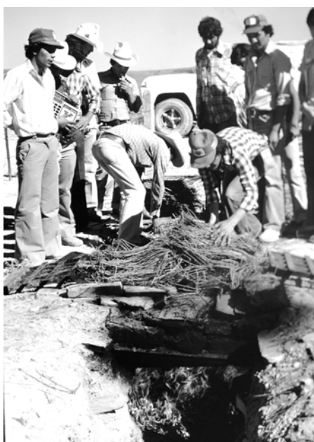
Figura 3.5. Cargando una paila. El agua que contiene se calienta pronto incrementando el fuego con residuos de extracciones anteriores.
