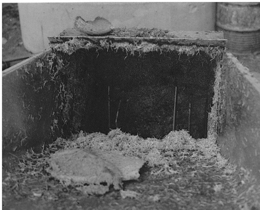
Figura 3.82. Detalle de un molino de martillos que fue adaptado para moler nopal.
