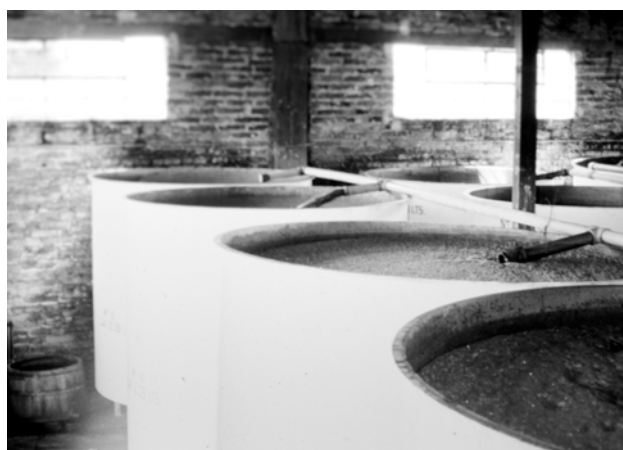
Figura 3.45. Con los jugos azucarados del agave se preparan los mostos, estabilizados a 10°Brix. Son fermentados durante 3 o 4 días en las tinas de fermentación, hasta que “mueren” a 0° o máximo 1°Brix .
