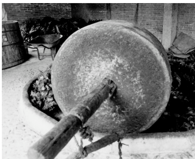
Figura 3.51. Molienda de las cabezas cocidas en el “paleque”, para extraer el jugo o mosto azucarado.
