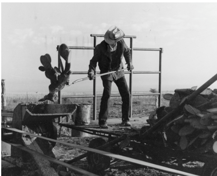
Figura 3.81. Un agricultor menonita, adaptó un viejo molino de martillos para moler plantas y pencas de nopal duraznillo.
