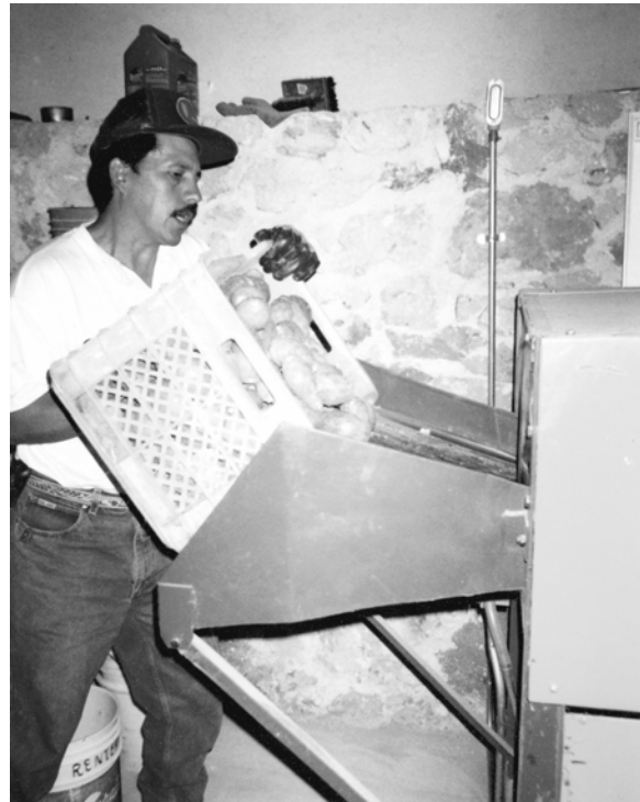
Figura 3.95. El nopal tunero produce frutos abundantes, de buen tamaño, agradable sabor y pulpa consistente. Máquinas adecuadas eliminan los “aguates” facilitando el empaque incluso para exportación.
