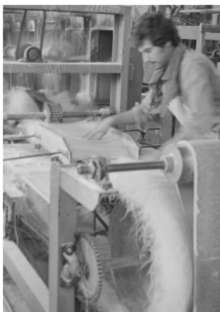
Figura 3.25. La fibra de lechuguilla pasa a una máquina que la acomoda preparándola para su clasificación.
