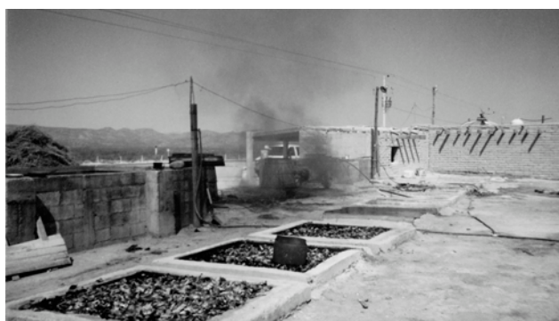
Figura 3.59. Para la elaboración del sotol se utilizan las “cabezas” o “piñas” de la planta de igual nombre. Se someten a un proceso de tatemado, picado y fermentación para obtener finalmente un destilado semejante al mezcal o tequila. Cuencamé, Dgo., 2005.
