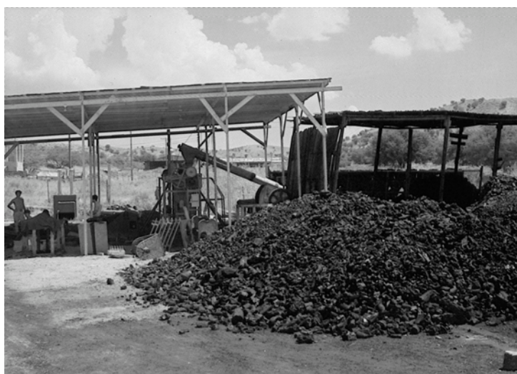
Figura 3.105. Pequeña industria donde se fabrican briquetas de carbón de mezquite. Durante el proceso se mezcla con residuos de vinaterías lo cual da a la carne asada un exquisito sabor. Nogales, Sonora, (ver Figura 3.104).
