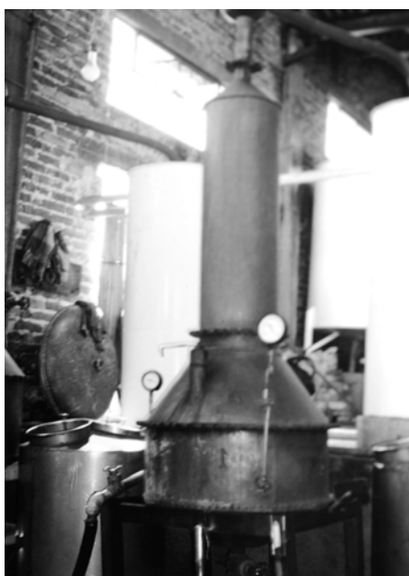
Figura 3.46. Alambiques “destrozadores”, en donde a partir de mostos fermentados (conocidos como mostos muertos) con 3.5 - 4 % de alcohol, se obtiene un 1er. aguardiente con 19 -200 G.L. Después se hace pasar por un alambique rectificador, para obtener el Tequila 30 - 55° G.L.
