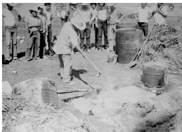
Figura 3.6. Campesino agregando ácido sulfúrico para curar el agua y acelerar el desprendimiento de cera de la candelilla en una paila cargada.
