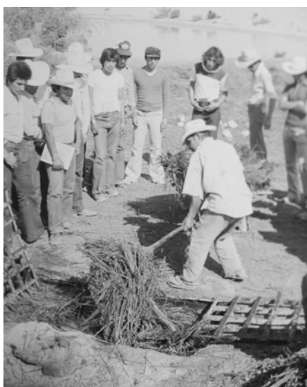
Figura 3.10. Descargando los residuos de la paila después de la extracción.
