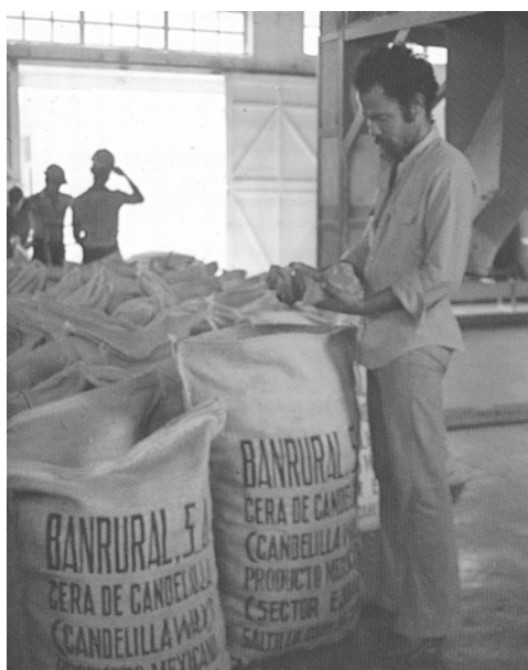
Figura 3.14. La cera de candelilla es partida con ayuda de mazos de madera, una máquina quebradora la reduce a trozos de tamaño irregular. Estos se empacaban en costales fabricados con fibra de palma samandoca. Se exporta a países industrializados.
