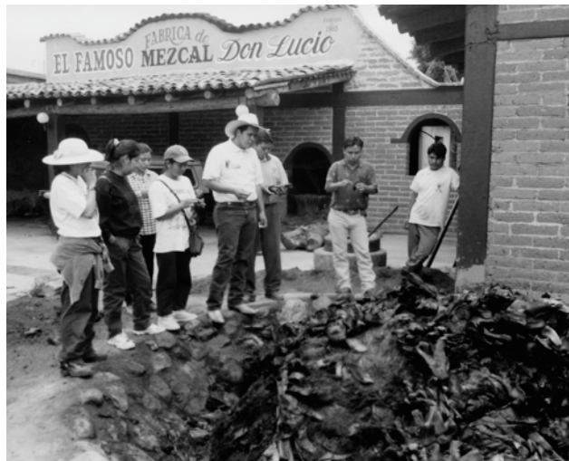
Figura 3.50. Tatemado o cocimiento de las cabezas o “piñas” de mezcal en “hornos” rústicos revestidos con piedras.
