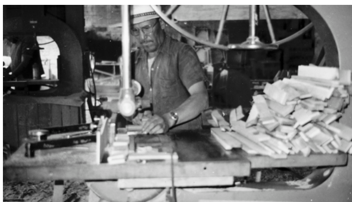
Figura 3.108. Aserrado de madera de mezquite para la fabricación de parquet para pisos. Guadalupe, Zac.
