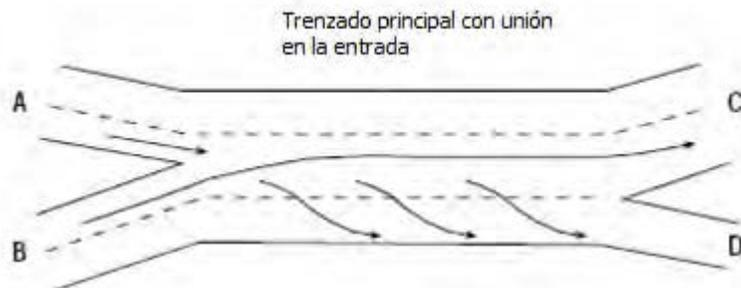
**Figura 4.3-5 Segmento de trenzado TIPO B**
