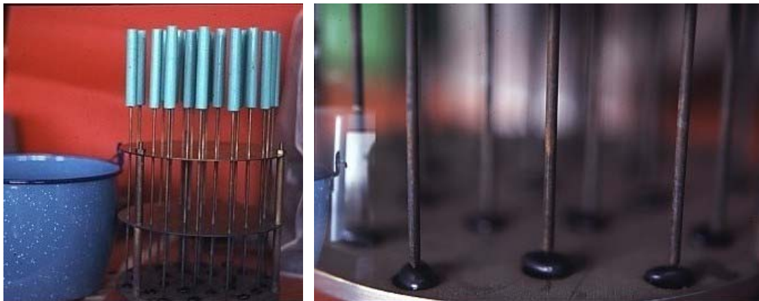
Figura 18 Cocinador Mattson modificado por Esquivel en 1994 antes de introducirse en la olla de peltre. En la parte derecha se ve un acercamiento para mostrar los frijoles con las varillas sobre ellos.
