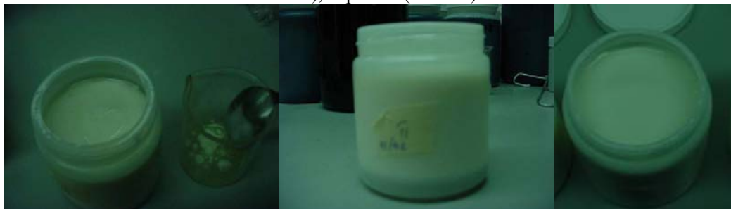
Figura A5.11. Emulsión E21-11 después del paso por la boquilla de atomización, depurada (izquierda y centro) al 13/02/09, al 15/07/10 (derecha)
