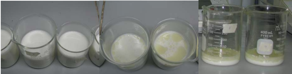
Figura A5.9. Emulsiones E21 después del paso por la boquilla de atomización, sin ruptura (izquierda), ruptura baja (centro), ruptura alta (derecha).
