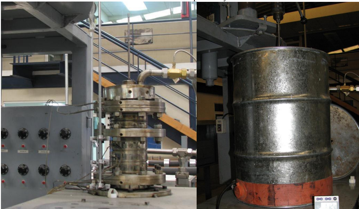
A4.5. Mezclador y tanque para producción de E20 y E21
