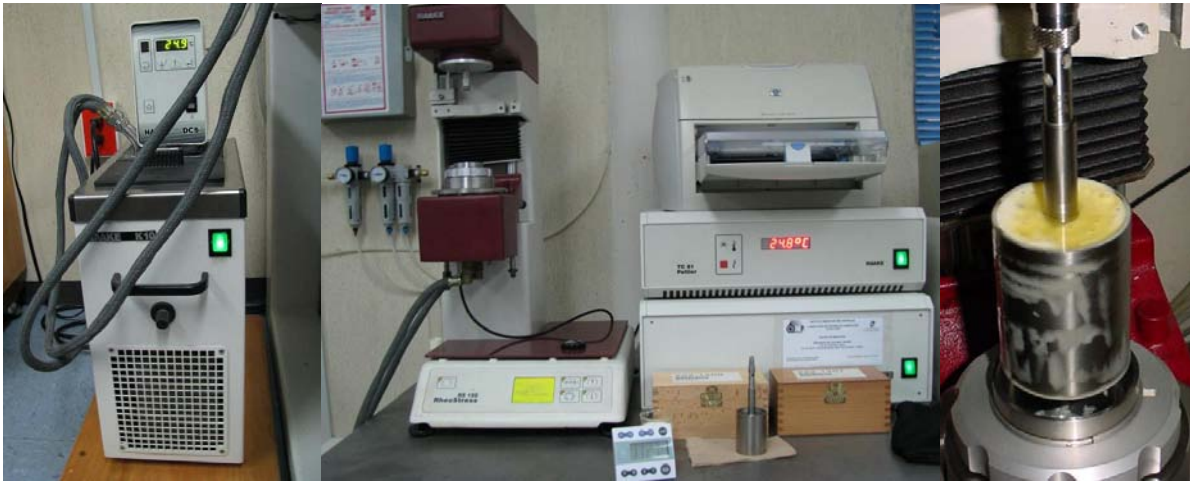
A4.4. Reómetro Haake RS150 con control de temperatura y sensor de cilindros concéntricos.
