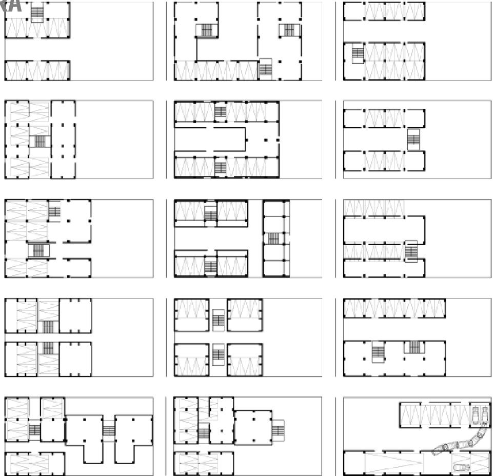
El estacionamiento puede ser determinante en la definición de la estructura, ya que la distribución de los cajones influye en los claros de la estructura. A continuación, algunas opciones de bloques formados así:
