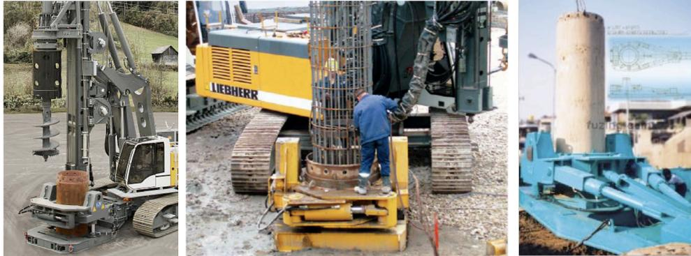
**Fig. 32. Izq. y Medio: Osciladora LIEBHERR. Der.:Osciladora Casagrande**
