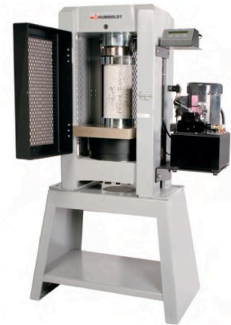
*Fig. 78. Cilindro probado a compresión*
