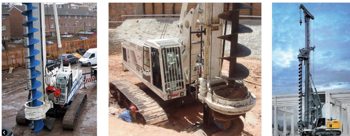
**Fig. 51. Izq. Hélice continua SOILMEC. Centro: Hélice continua MAIT. Der. Hélice continua LIEBHERR**
