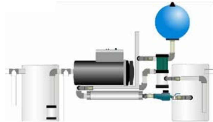
Fig. 1.37 Vista de equipo marca GRISOL propuesto para la reutilización de las aguas grises en el proyecto.
