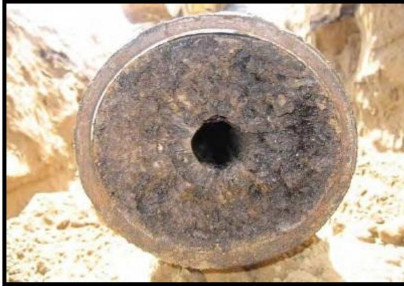
**Figura 6.5. Sección de tubería de línea de escurrimiento con depósitos de asfaltenos<sup>18</sup>.**
