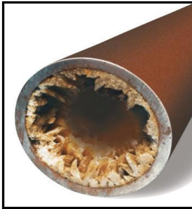
**Figura 6.6. Incrustaciones de carbonato de calcio en una tubería de producción<sup>29</sup>.**
