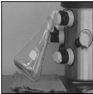
Figura 20. Dispositivo montado en la liofilizadora
