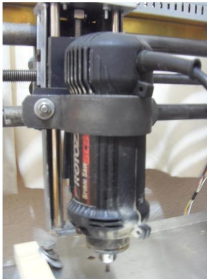
*Figura 2.2: Router utilizado*
