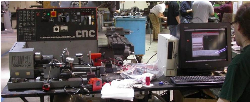
*Figura ii: Modernización de torno EMCO*
