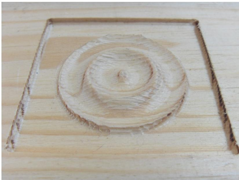
*Figura 4.9: Maquinado de superficie*
