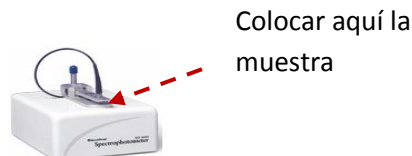
Figura 5: Espectrofotómetro, para cuantificar concentración de DNA
