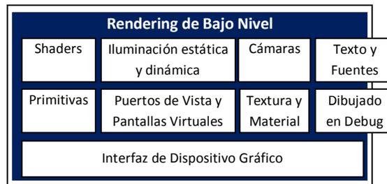
Figura 3.6. Subsistema de rendering de bajo nivel
