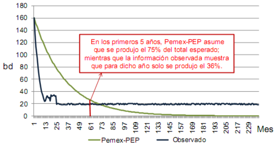
Grafica 11 Curva de producción mensual estimada por PEMEX-PEP y Observada* (barriles diarios)
