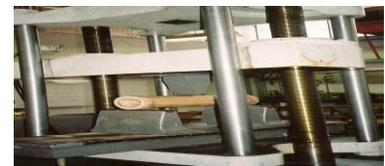
**Foto g** Prueba de flexión con nudos a los extremos
