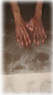
Figura 31 Pegado de tela sobre bastidor
