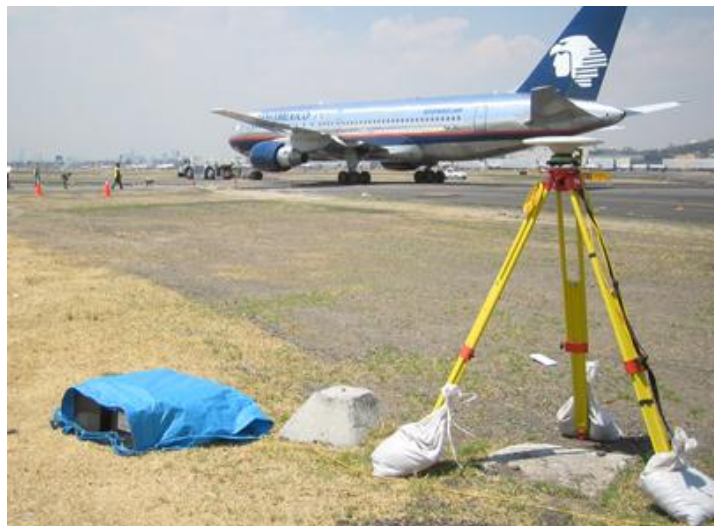
Fig. 3.2. Instalación completa de un equipo GPS Trimble5700.
