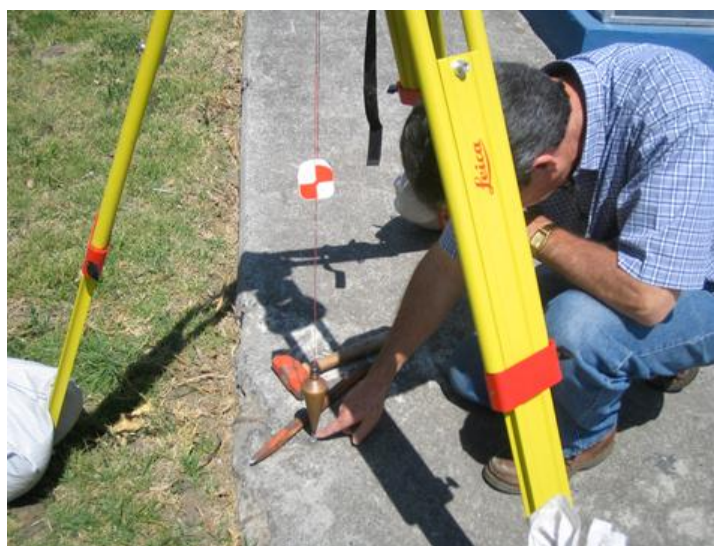
Fig. 3.1. Instalación y nivelación del equipo.
