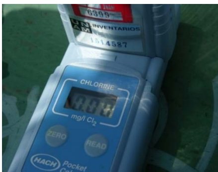
Figura 4.4 HACH POCKET-Diseñado para la medición colorimétrica a una longitud de onda de 528nm.
