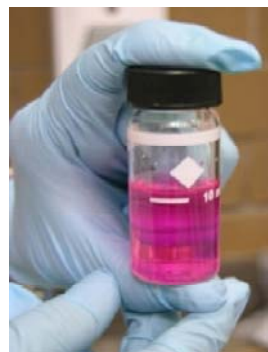
Figura 4.5 Celda para cloro residual.
