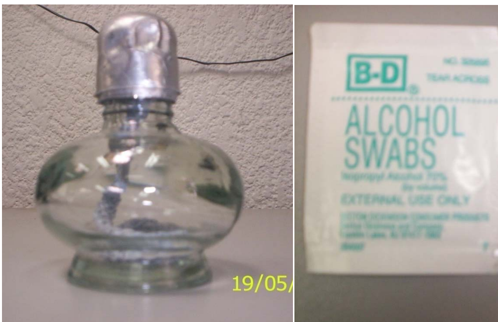
Figura A2.3 Mechero de alcohol y alcohol isopropílico utilizados en la toma de muestras en grifos para la determinación de Coliformes Totales.
