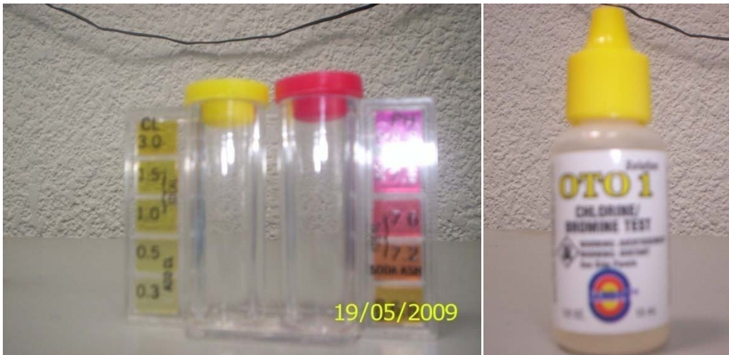
Figura A2.2 Equipo de campo para medición de Cloro residual libre con el método de la ortotolidina
