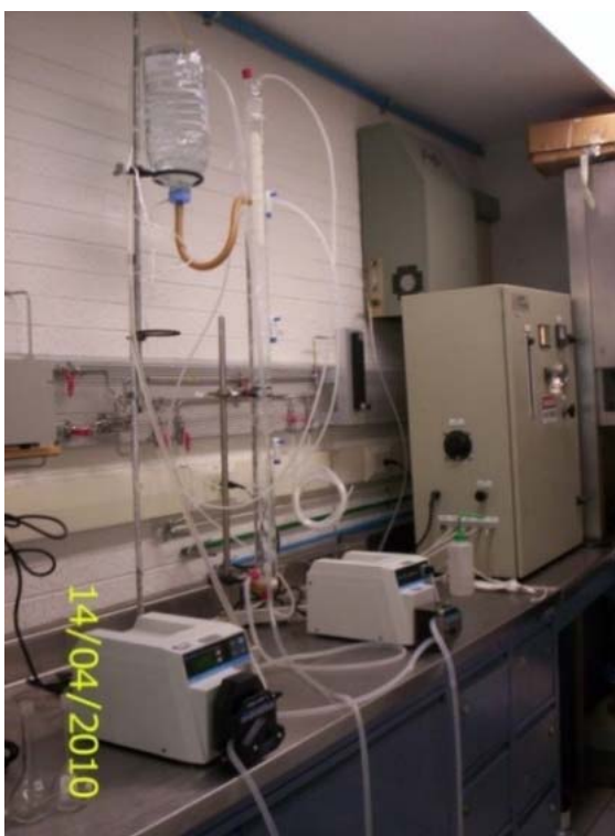
Figura 4.2 Sistema de oxidación con ozono en modo continuo.
