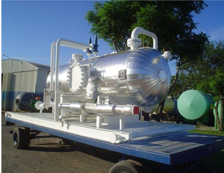
Fig. 1.10 separador horizontal trifásico. (Ref. 33)
