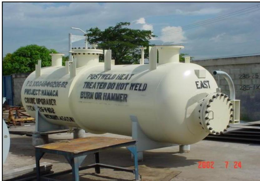
Fig.1.8 Tanque horizontal líquido-líquido (Ref.33)
