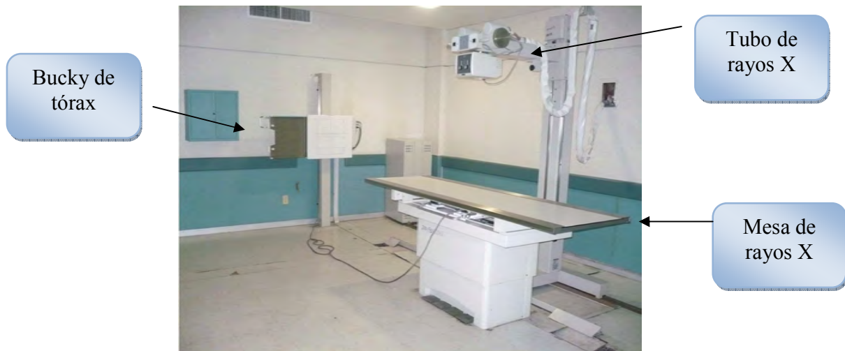
Figura 3.2. Equipo de rayos X, marca CMR, en un hospital de la Ciudad de México.
