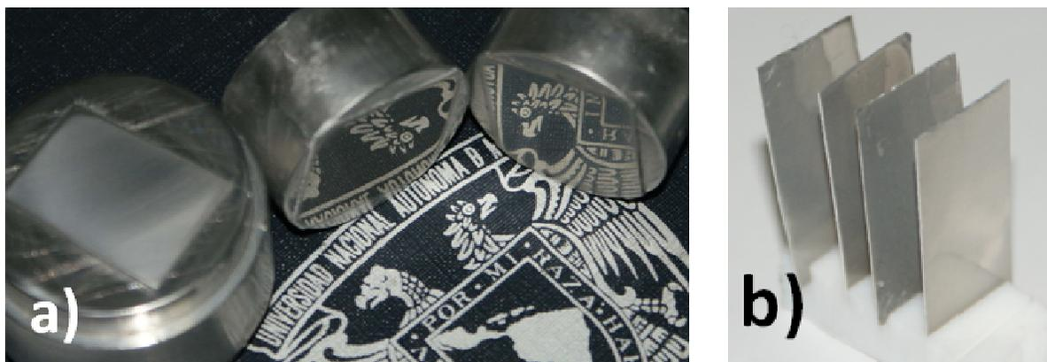
**Figura 2.7.** a) Láminas de aluminio pulidas hasta lograr un acabado tipo espejo. b) Tamaño final de las muestras colocadas en un soporte de teflón.
