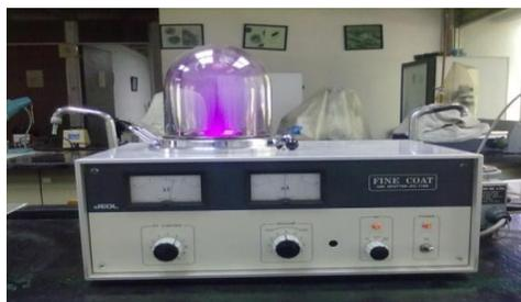
Figura 13. Recubrimiento de oro de las muestras de HEMA.
