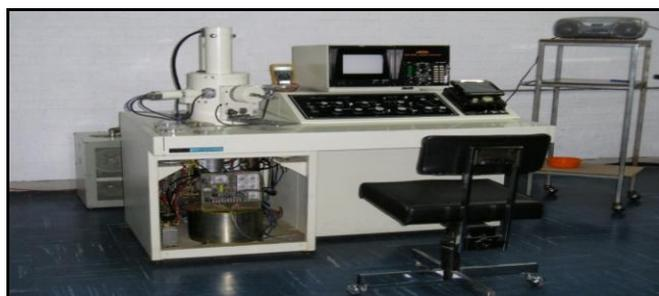
Figura 14. Microscopio electrónico de barrido.
