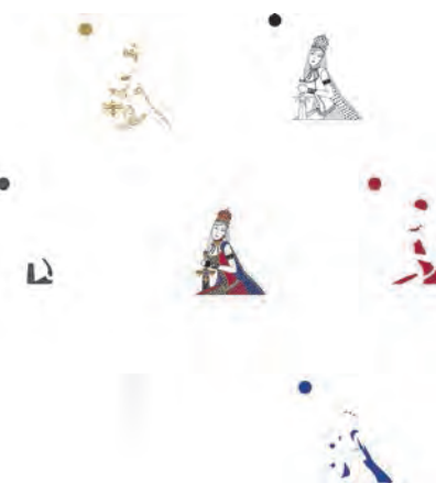
Figura 3.11: Para imprimir una imagen a color plana o hecha a línea hay que separarla por color y hacer una matriz para cada uno.
