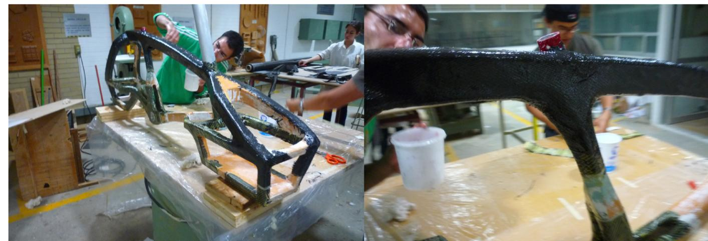
Figura 50. Aplicación de las capas en fibra de carbono.
