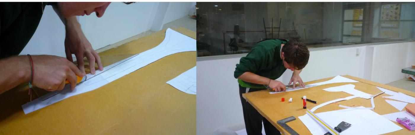
Figura 44. Corte de las plantillas en estireno.
