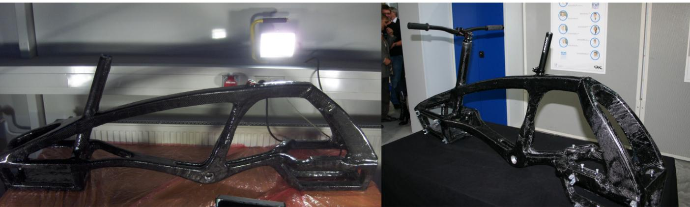
Figura 51. Aplicación de la última capa de fibra y de resina epóxica para el acabado final.
