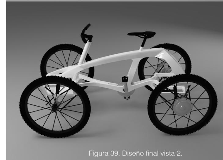
triángulo que forma el marco lo hace muy resistente para terrenos difíciles donde se envuelven muchas fuerzas, esta forma conserva la idea de todas las bicicletas. El marco esta hueco lo que permite que los cables para el sistema híbrido y los frenos puedan ir en el interior al mismo tiempo alberga la batería lo que le da mucha limpieza al diseño.
