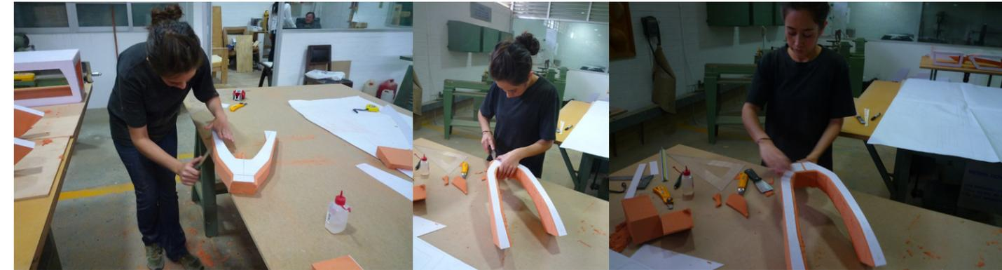
Figura 45. Corte y esculpido de las secciones en espuma.
