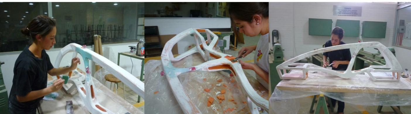
Figura 48. Aplicación de blanco de España para rigidizar la espuma.
