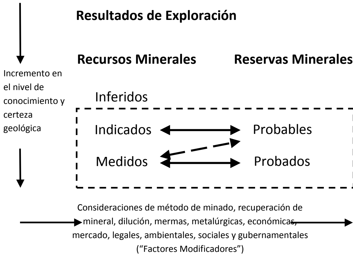
Figura 15.7.1 Esquema de Resultados de Exploración, Recursos Minerales y Reservas Minerales en criterios CRIRSCO.
