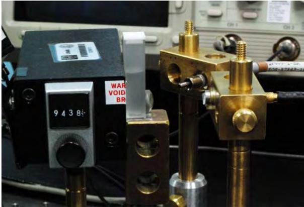
**Fig.5.3. Vista del monocromador con celda de cuarzo, lente de cuarzo, monocristal, sensor piezoeléctrico y fibra óptica del espectrómetro. La luz que es transmitida por la celda y la lente es vista por el espectrómetro y el sensor.**
