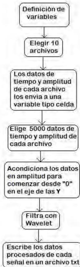
**Fig.5.5 Diagrama de flujo del programa de procesamiento de señales escrito en Matlab**
