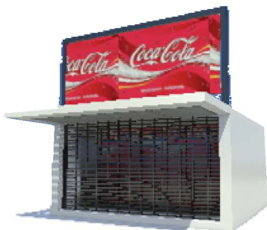
Figura P.1: Modelo tridimensional basado en un diseño de la Muscipula de Venus, donde el cierre-trampa se halla oculto tras el rótulo que anuncia el giro de la tienda. El dispositivo consta de sistema de enrejado de guillotina, que puede cerrar completamente el espacio en pocos segundos, sin conceder oportunidad al asaltante de huir.
