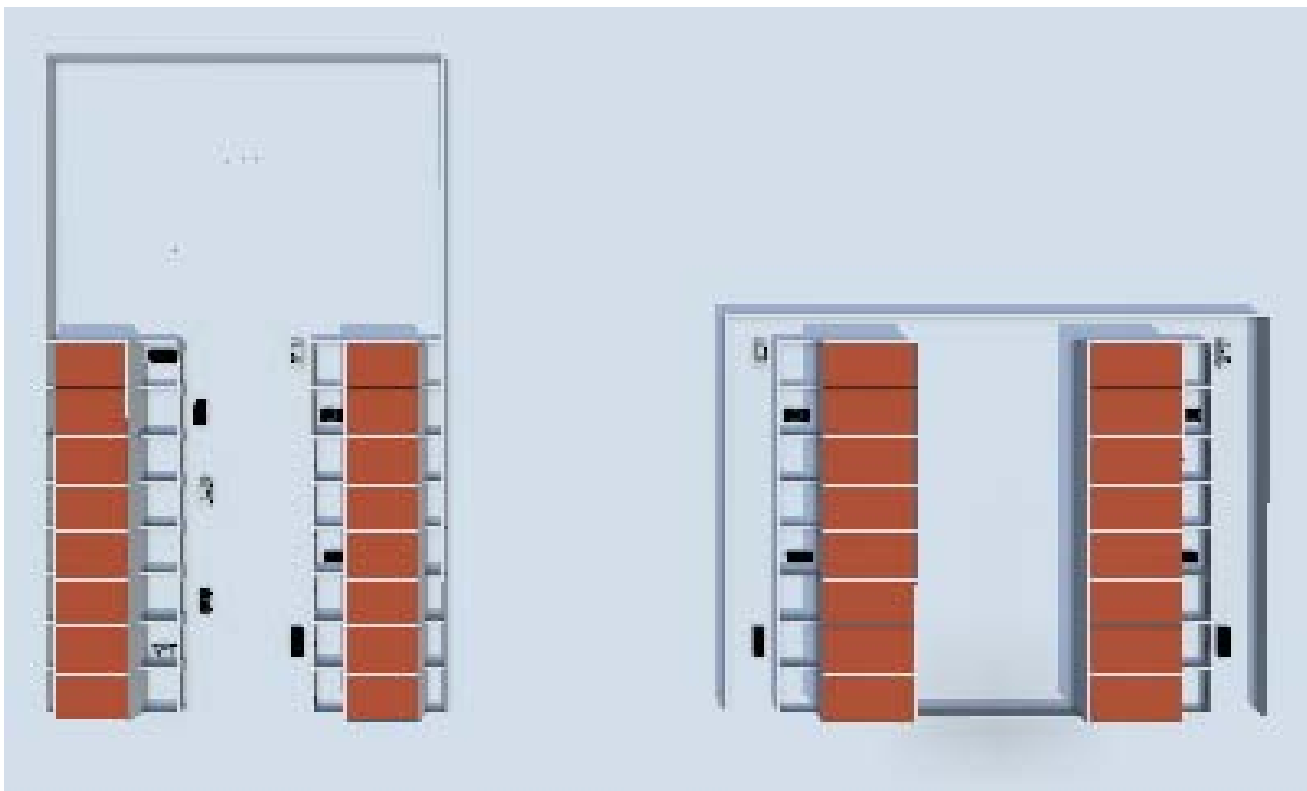
Figura P.5: El siguiente esquema muestra una alternativa de funcionamiento en una privada modelo, donde los frentes de cada una de las viviendas dispuestas en hilera, se han invertido, ubicando sus zonas de descanso y recreación pública frente a un `core´ o un patio comunal y libre de flujo vehicular. Mientras tanto, las cocheras se han cargado hacia los extremos opuestos, donde las entradas y flujo vehicular se separan definitivamente del centro de la privada. Hay dos cosas importantes dignas de notar; primero, que el área tanto de las viviendas en particular se ha incrementado, en tanto que el área general que ocupa la lotificación ha disminuido y, segundo; que el núcleo común que se localiza al centro de la privada permite numerosas actividades de convivencia vecinal que no tiene la propuesta convencional.
