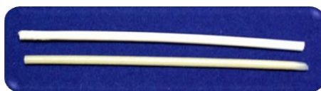
Figura 16. Molde cilíndrico WOW y varilla de acrílico lograda.
