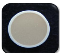
Figura15. Moldes de PVC con el sustrato de PMMA.
