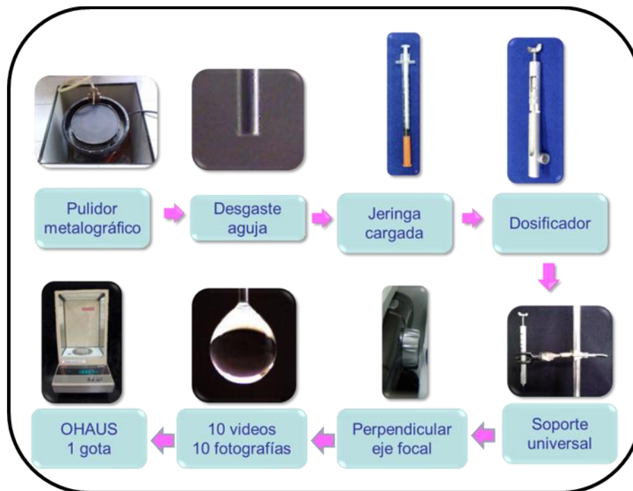
Figura 27. Medición de diámetro y peso de la gota
