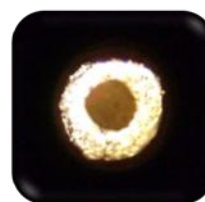
Figura 34. Vista de la punta de la aguja con microscopio óptico (125 X).
