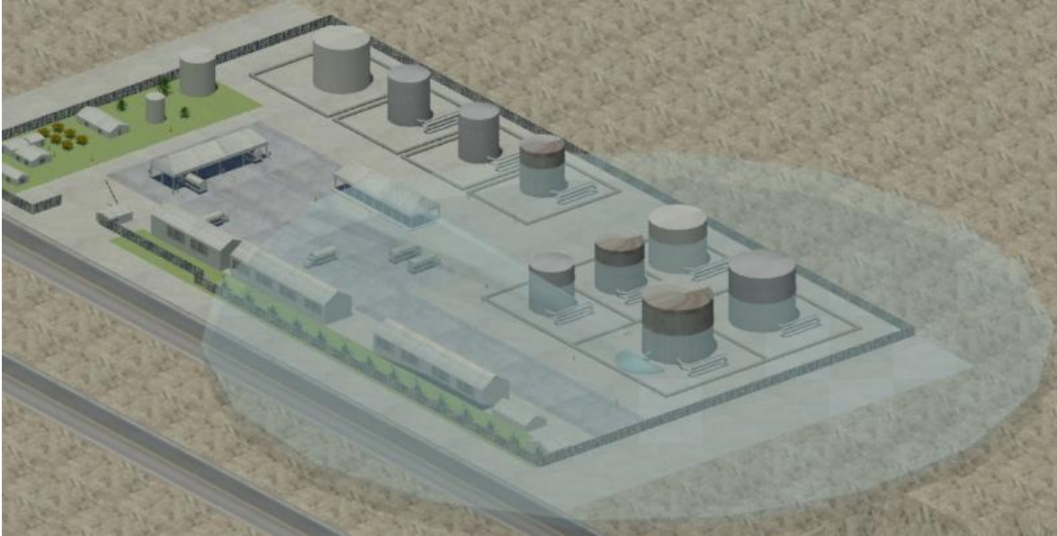
Figura 2.4: Dispersión de una nube de vapor sobre el modelo virtual creado en 3d max.
