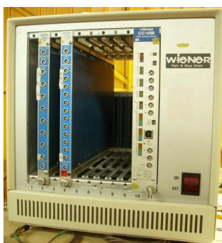
Figura 5.25: Sistema electrónico nuclear CAMAC.
