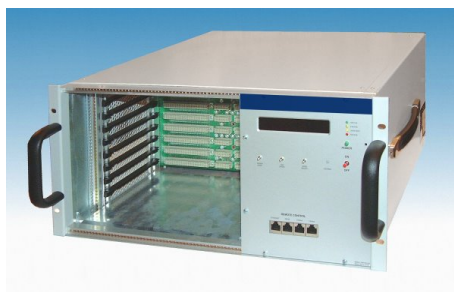
Figura 5.27: Sistema electrónico VME (Versa Module Europa).
