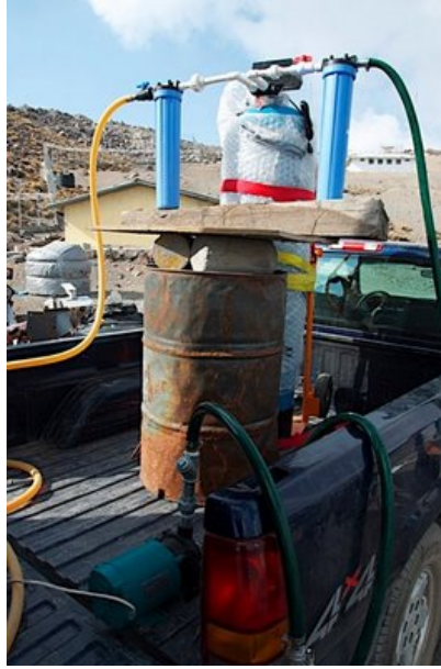
Figura 5.12: Proceso del filtrado de agua, para el llenado de los tanques del prototipo HAWC.
