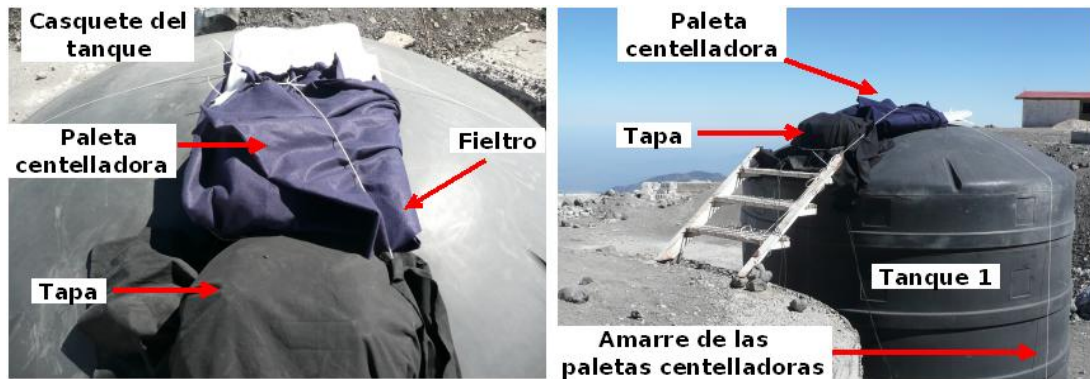
Figura 5.45: Montaje de la paleta centellador en la parte superior del tanque 1, cubierta con fieltro oscuro para el aislamiento óptico de la luz natural y protegida con hule espuma para evitar daños.
