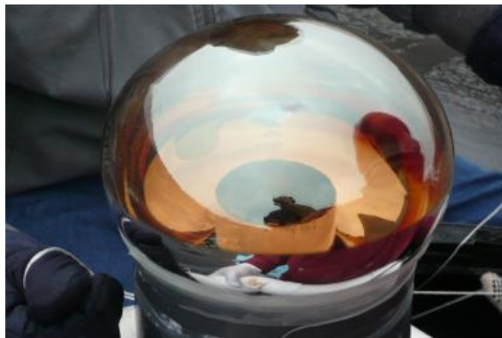
Figura 5.62: Superficie del fotocátodo del PMT Hamamatsu.
