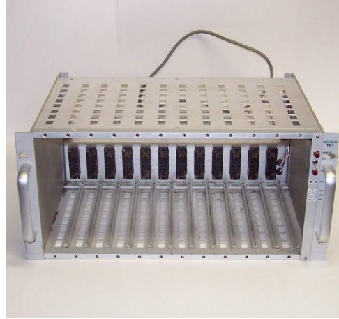
Figura 5.19: Sistema electrónico nuclear NIM bin.
