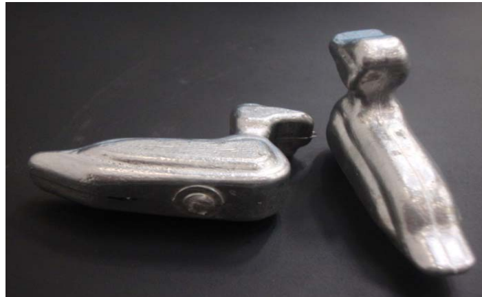
Figura 2.33. Pieza obtenida con las líneas de respiración de una de las placas, con barrenos en la parte lateral de la cavidad, una temperatura del aluminio de 800° y reducción en la entrada de la cavidad.
