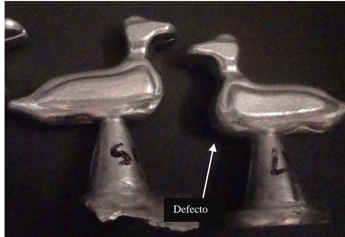
Figura 2.28 Piezas obtenidas con una temperatura del aluminio de 800° C y sin reducción del diámetro en la entrada de la cavidad, donde se observa que el defecto continua pero en menor proporción.
