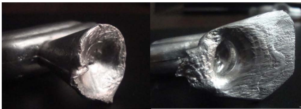
Figura 2.29 Revisión de coladas, aquí se observa que el rechufe se da en mayor proporción que en los casos anteriores, lo que nos indica que la mazarota realiza su tarea de forma adecuada
