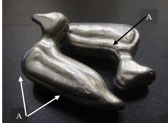
Figura 2.31. Piezas obtenidas con los cortes de salida de aire en una cara de las caras de ensamble del molde
