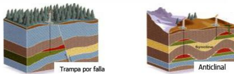
Fig. 1.5 Ejemplos de trampas estructurales falla y anticlinal
