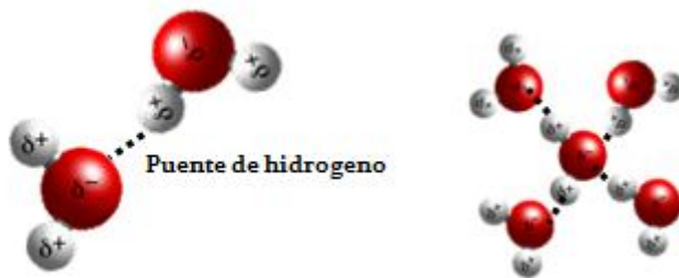
Fig. 2.7 Los puentes de hidrogeno entre dos moléculas de agua. Las cargas parciales de la molécula le permiten unirse a otras cuatro moléculas de agua. Muchas de las propiedades únicas del agua, como ser casi el disolvente universal se deben a su capacidad de formar puentes de hidrogeno.
