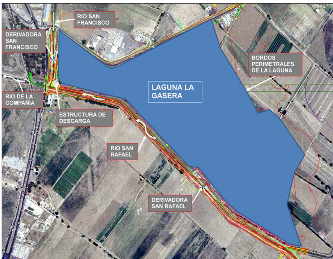
Figura 1. 1 Configuración general de la laguna La Gasera.
