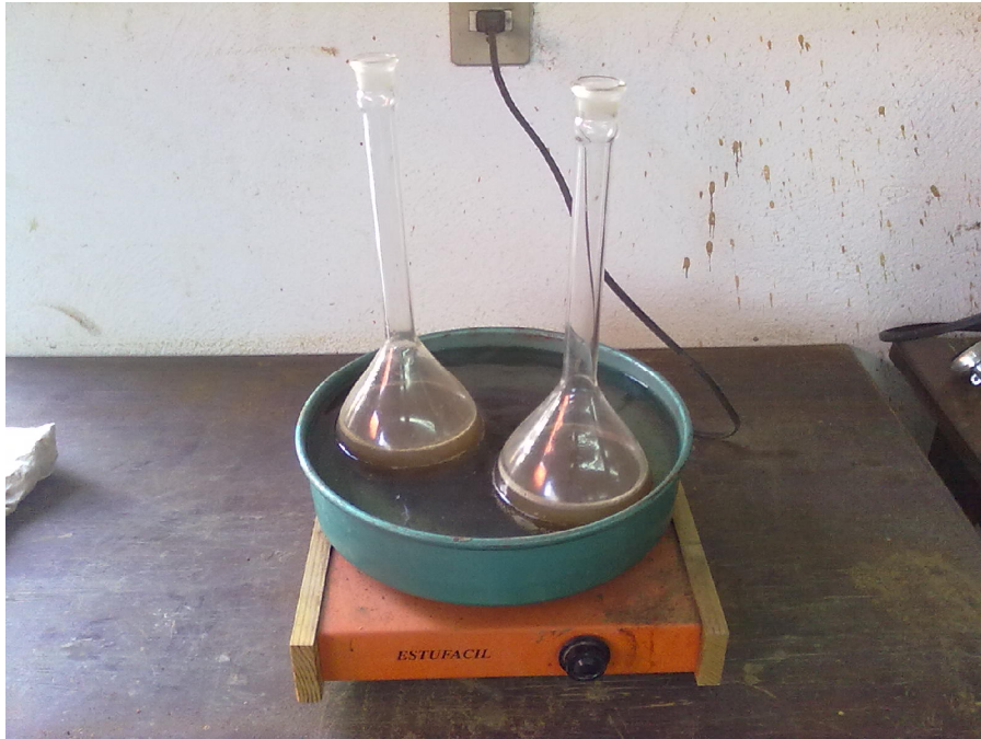
Fotografía 5.2. Muestra de suelo en el matraz para la calibración de la prueba de densidad de sólidos.
