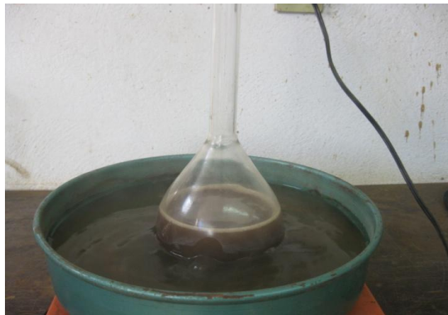
Fotografía 5.12.- “Remoción incompleta de las burbujas de aire”.
