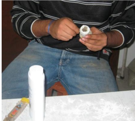
Fotografía 5.29.- “Colocación de la membrana de látex”.
