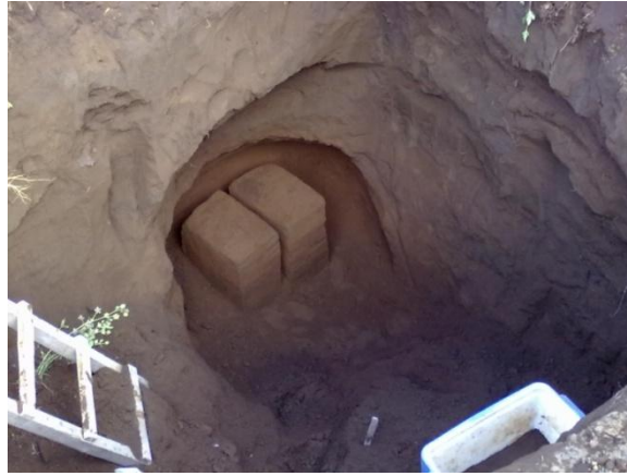
Fotografía 5.4.- Obtención de la muestra inalterada.
