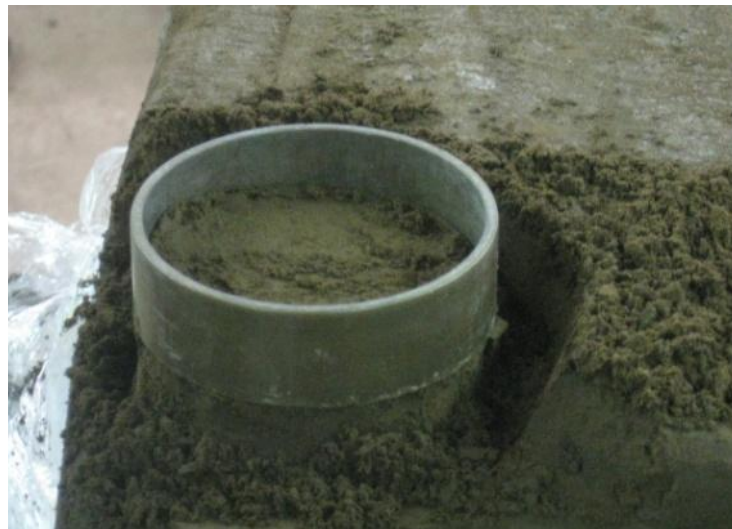
Fotografía 5.22.- “Colocación de la muestra en el anillo de consolidación”.
