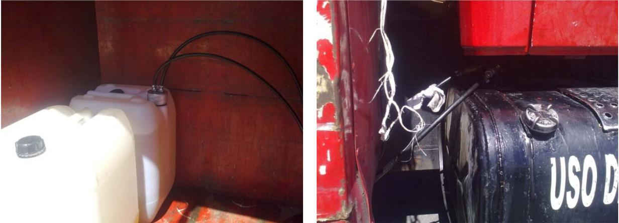
Imagen 3.5 Sistema utilizado para la sustitución del tanque de combustible
