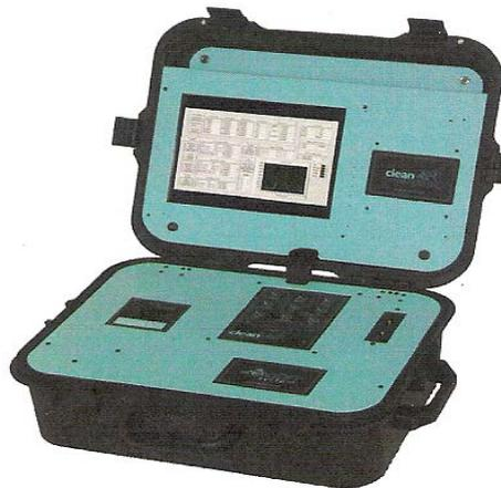
Imagen 3.2 Sistema Portátil de Medición de Emisiones Axion
