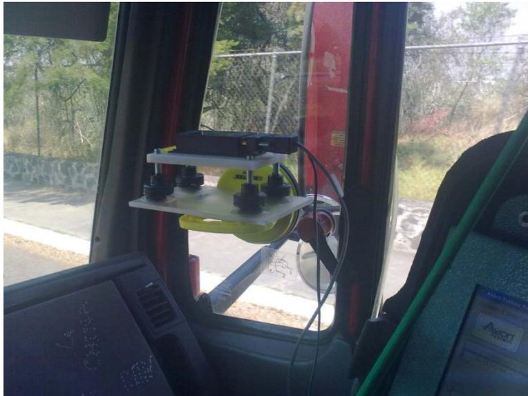
Imagen 3.6 adaptación realizada al inclinómetro para realizar mediciones.
