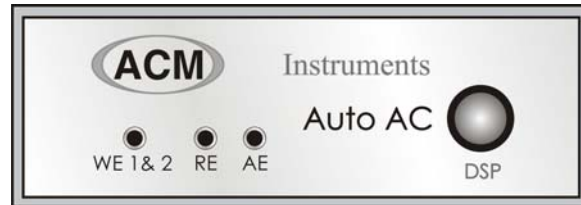
Figura 4.10. Potenciostato ACM utilizado en la prueba de curvas de polarización.
