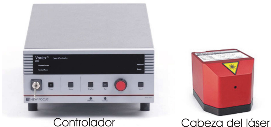
Figura 5.1: Láser NewFocus Vortex 7000. Controlador y cavidad extendida.
