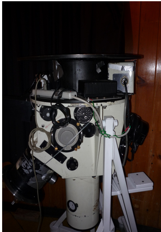
Figura 4.3: Espectrógrafo Boller & Chivens. Foto tomada por el Dr. David Mitchell Clark, Astronomo residente del Observatorio de San Pedro Mártir.
