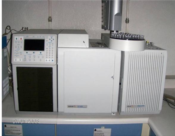
**Figura 3.2.** Cromatógrafo de gases acoplado a un espectrómetro de masas/masas
