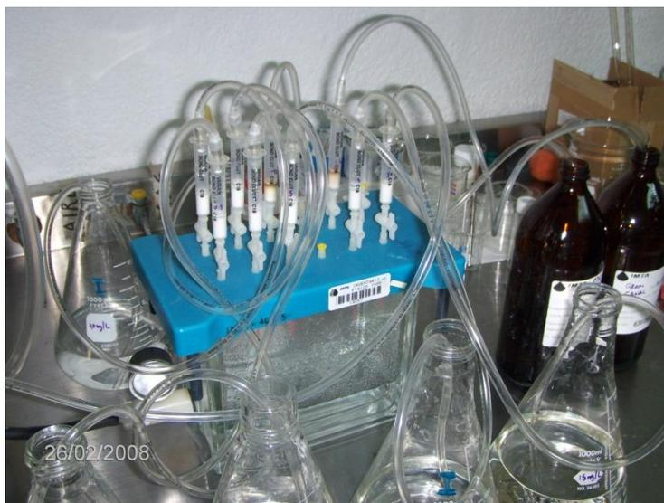
**Figura 3.3.** Sistema de extracción en fase sólida
