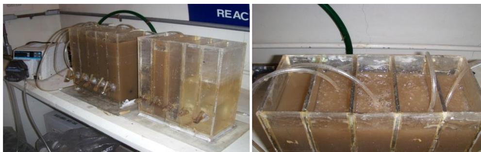
**Figura 3.7.** Esquema experimental utilizados en las cinéticas de remoción
