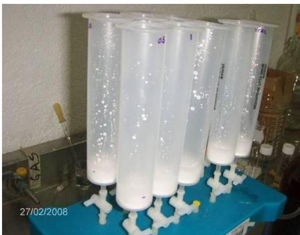
**Figura 3.4.** Sistema de limpieza en cartucho con silica gel
